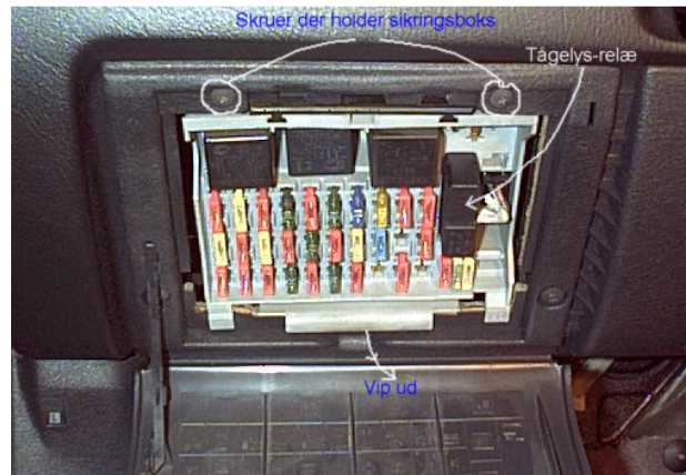
Tågelys-relæet er placeret i sikringsboksen
